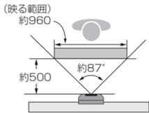
下図のように、標準位置より低い位置や、左または右に離れた位置に設置する場合には、カメラ角度調節レバーで、撮影範囲を調節できます。(※「目ドアホンを取り付ける」手順3)
