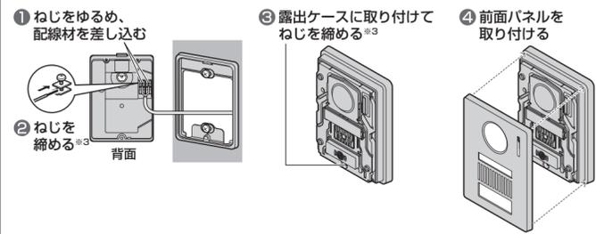
※3 電動ドライバーなどを使う場合は、ねじの破損防止のため、締め付けトルクを0.7 N・m(7 kgf・cm)以下に設定してから固定してください。
