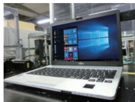
液晶ディスプレイの開閉動作を繰り返し、破損などがいないか、耐久性のチェックを行います。
