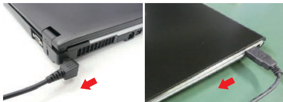
コネクタ部の耐久性を確認するため、ACアダプター、USB、PCカードなどの各種インターフェースに対し、コネクタ挿抜の繰り返しや、大きな力で引っ張るといった試験を行い、強度のチェックを行います。
