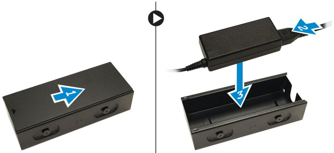
2. ケーブルをボックスに差し込み、カバーを後方へスライドさせてロックします。
