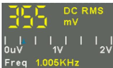
DVMボックスの中央に表示されるのは、現在測定されている電圧値と、選択したVOLS/DIV ([VOLS/DIV]ノブを回す)の画面上の8つの垂直グリッドに対応する範囲の対応する比率です。
